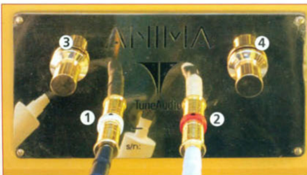
Vue de la plaque technique avec bornier HP de haute définition (1 et 2) ainsi que les réglages respectifs (3/4) du niveau du médium et de celui de l'aigu en fonction de l'acoustique de la pièce mais aussi de la distance par rapport à la zone d'écoute, très important pour avoir une bonne cohérence de l'ensemble de la diffusion.
